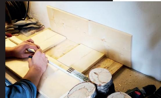
2. Rahmen ausmessen (passend zur Größe des Koffers) und Bretter für die Zwischenfächer zusägen.
